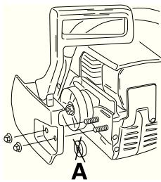
Установите пильное полотно на специально предназначенные болты. Установите полотно в самое заднее положение. Оденьте цепь на ведущую звездочку и вставьте ее хвостовики в паз пильного полотна. Начинайте с верхней стороны пильного полотна.
