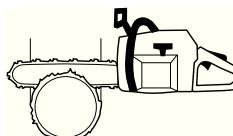
Существуют методы валки деревьев с полотном, меньшим диаметром ствола. Однако эти методы достаточно опасны, т.к. область отдачи полотна входит в контакт с предметом.
