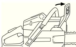
**Зажигание:** Установите переключатель зажигания в левое положение.
