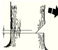
Вставьте зубчатый упор (если установлен) сзади надреза. Работайте на полном газу и водите пильное полотно в ствол дерева постепенно, плавным движением. Следите за тем, чтобы дерево не начало перемещаться в направлении, противоположном предполагаемому направлению падения. Как только пропил станет достаточно глубоким, загоните в него клин или вагу.
