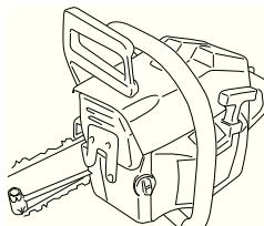
Цепь считается натянутой правильно, если она свободно проворачивается рукой. После этого , удерживая носок пильного полотна в вверхнем положений, затяните гайки крепления пильного полотна универсальным ключом.
