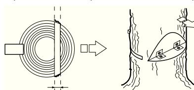
Возможность влияния на направление падения будет полностью утрачена, если полоса разлома слишком узкая или пропилована направляющий и основной пропилы плохо размещены.
