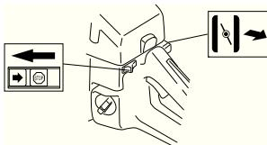
Если машина оборудована декомпрессионным клапаном (A): Его необходимо нажать, чтобы уменьшить давление в цилиндре и облегчить запуск машины. При запуске машины всегда пользуйтесь декомпрессионным клапаном.
