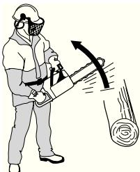
Проверьте, чтобы вы стабильно ишли и стояли. Во время работы стойте с левой стороны дерева. Для максимального контроля пилу следует держать как можно ближе. По возможности весь вес пилы следует направить на ствол.
