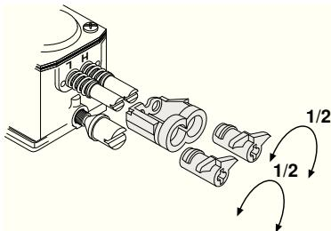
Если Ваша моторная пила оснащена карбюратором с ограничителем выходной мощности, то такой карбюратор следует регулировать согласно указаниям в разделе Карбюратор с ограничителем выходной мощности.
