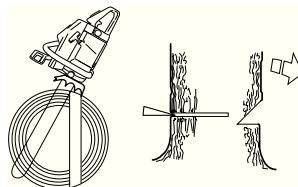
Закончить основной пропил нужно параллельно линии направляющего пропила так, чтобы расстояние между ними составляло около 1/10 диаметра ствола. Нераспиленный участок ствола называется полоса разлома (недопил). Полоса разлома действует как петельный щарнир, задающий направление падения дерева.
