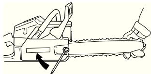
При установки новой цепи следует часто проверять ее натяжение , пока цепь не приработается. Регулярно проверяйте натяжение цепи. Регулярно проверяйте натяжение цепи. Правильно натянутая цепь обеспечивает высокое качество пиления и дольше служит.
