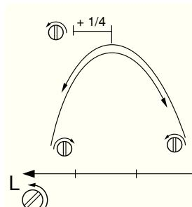
ВНИМАНИЕ! Если цепь вращается в течении холостого хода вам надо повернуть винт Т против часовой стрелки до ее полной остановки.
